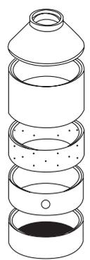
Auch für den privaten Hausbau sind diese Schacht- und Brunnenringe sehr preiswert einsetzbar. Sie ermöglichen einen sauberen und schnellen Baufortschritt beim Hausbau und können als Brunnen, Sickerschächte, Putzschächte und Senkgruben eingebaut werden.
