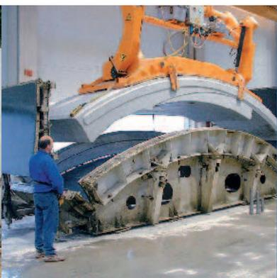
Tübbinge dienen zur Auskleidung von mechanisch vorangetriebenen Tunneln. Sie haben ein Stückgewicht von 16 Tonnen, die im Verbund mit weiteren 5 Tübbing-Elementen, einen Kreisquerschnitt von 12,60 m bilden.
