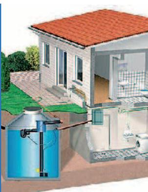
Regenwasserspeicher dienen zur ökologischen Nutzung von Brauchwasser. Sie können mit Armaturen wie Filter und Entnahmeleitungen zur direkten Versorgung der Brauchwasser-Hausleitung ausgestattet werden.
